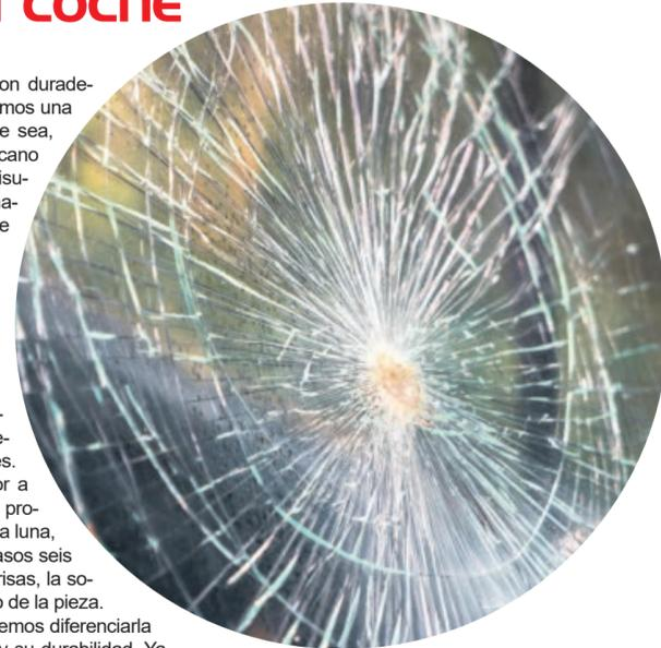
En el caso de rayaduras o porosidades marcadas (normalmente causadas por un mal mantenimiento de los limpiaparabrisas), a menos que dificulten la visión no son causa de rechazo en la inspección técnica. Si nos supone una ITV negativa un cristal rajado o roturas en forma de estrella, sea del tamaño que sea y se encuentre o no en el campo de visión.
